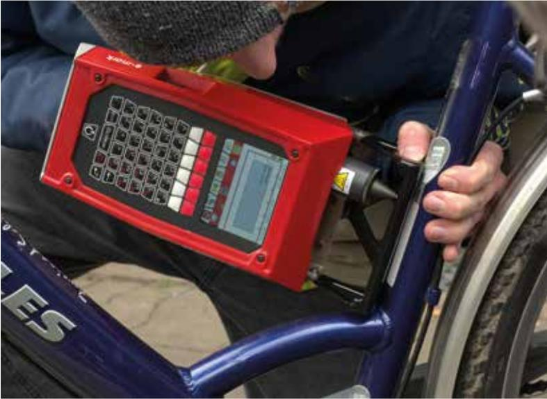
nicht beeinträchtigt wird. Auf diese Weise lässt sich der Code in wenigen Sekunden anbringen. Um Lackschäden zu vermeiden, wird zunächst eine Grundierfolie aufgeklebt und die Codierung mit einem Hinweis-/Schutz-aufkleber versiegelt.
